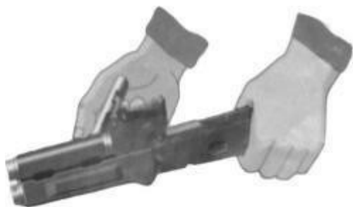
Рис. 7.17. Отделить затвор от затворной рамы
