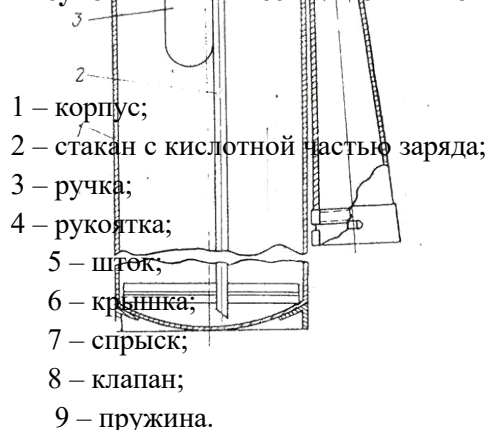
Рисунок 1 - Химический пенный огнетушитель ОХП – 10
