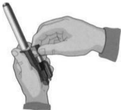
Рис. 7.16. Отделить затворную раму с затвором
