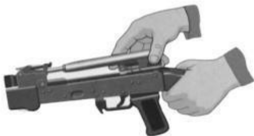
Рис. 7.16. Отделить затворную раму с затвором
