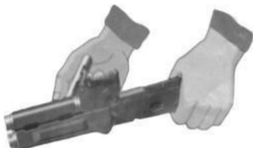
Рис. 7.17. Отделить затвор от затворной рамы
