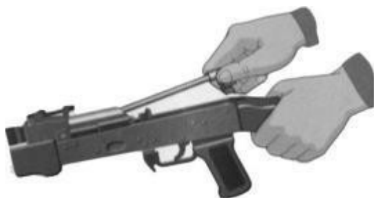
Рис. 7.14. Отделить крышку шомпол ствольной коробки
