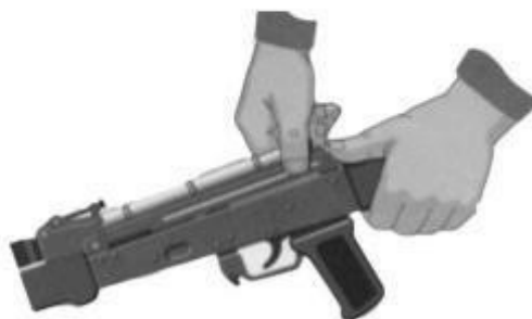
Рис. 7.14. Отделить крышку шомпол ствольной коробки
